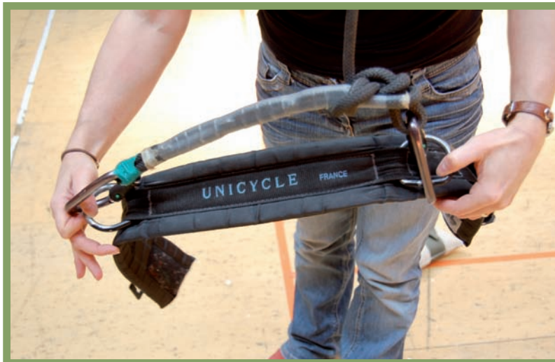
fig. 2 Système de harnachement « antichute » avec double mousqueton
