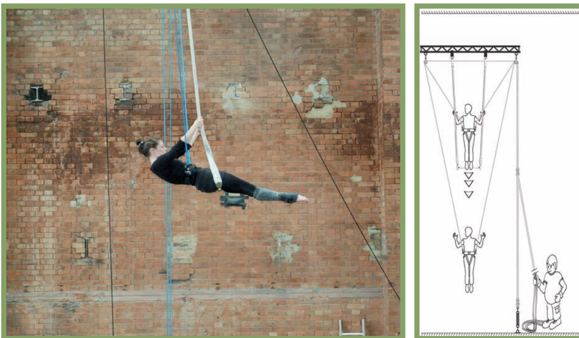
fig. 1 Double système de harnachement avec deux cordes à l'extérieur de la ligne du trapèze.
